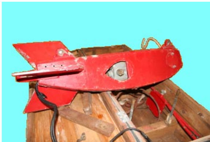
“Dorrestein-vis”, zonder registratieapparatuur. Foto: KNMI (Frits Koek, 2010)
